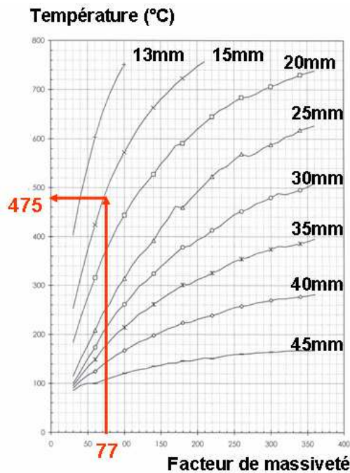
Figure 3 : Température maximale dans l'acier
