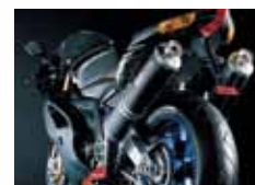
L'acier inoxydable noirci est couramment employé pour les essuie-glaces et les pièces décoratives des motos. Photo : Steel Color, Pescarolo Ed Uniti (I)
